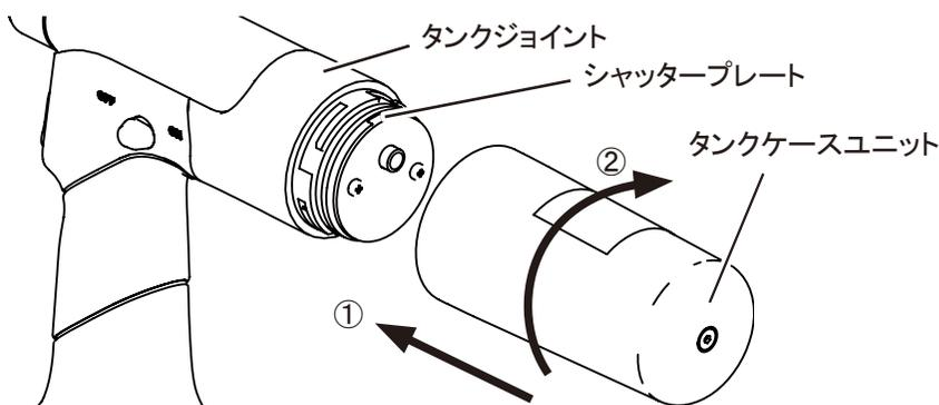
シャッタープレートとタンクケースユニット内の切り欠けを合わせてタンクジョイントに押し当て（①）、タンクケースユニットを時計回りに回して（②）装着します。
